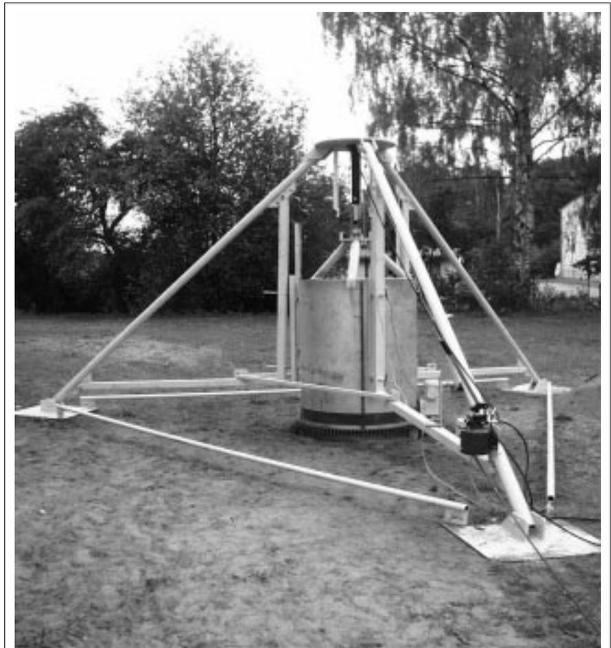
Abbildung 1: Vorrichtung zur Entnahme großvolumiger Bodenmonolithe (Gesamtansicht mit Lysimetergefäß)
