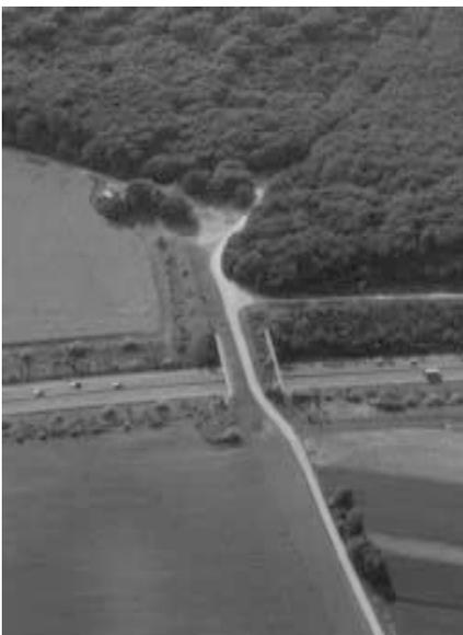
**Abbildung:** Auch schmälere Querungsmöglichkeiten (Typus C) sind für Wildtiere wertvoll, sofern sie unversiegelt sind, Deckungsmöglichkeit bieten und mit den Lebensräumen im Umfeld gut vernetzt sind (z.B. direkter Waldanschluss). Verbesserungsbedarf ist in der unteren Bildhälfte deutlich erkennbar (z.B. Gehölzstreifen als Leitstrukturen).
