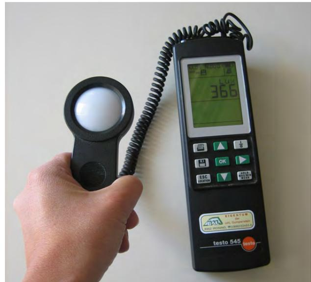
**Abbildung 2: Luxmeter zur Messung der Beleuchtungsstärke**
