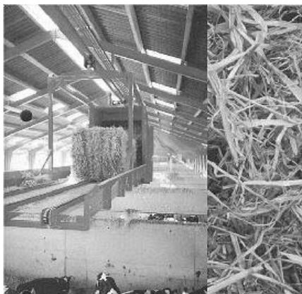
Abbildungen 1 und 2: Schienengeführte mobile Systeme mit mitgeführten Großballen (Rund- oder Quaderballen) mit integriertem Strohhäcksler zur breitflächigen Verteilung im Stall.
