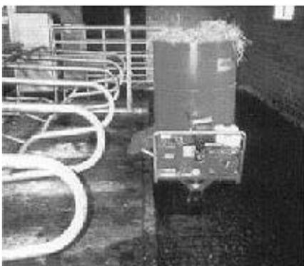
*Abbildung 4: Mobile Strohmühlen mit eigenem Motor mit seitlichem Auswurf*
