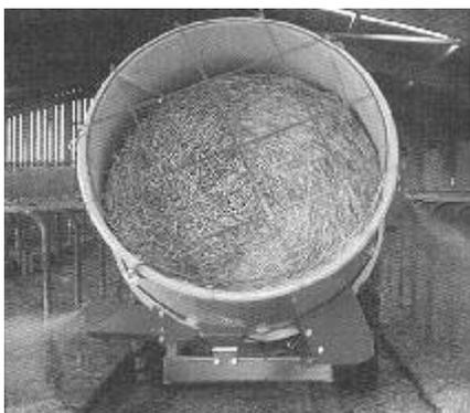
*Abbildung 3: Mobile Strohmühle als Anbaugerät für den Traktor*
