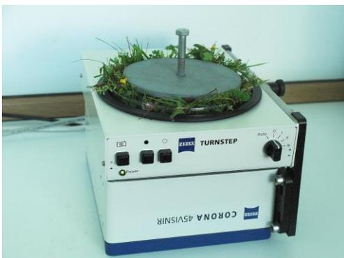
Abbildung 8: Farbmessung mit NIR-Spektrometer
