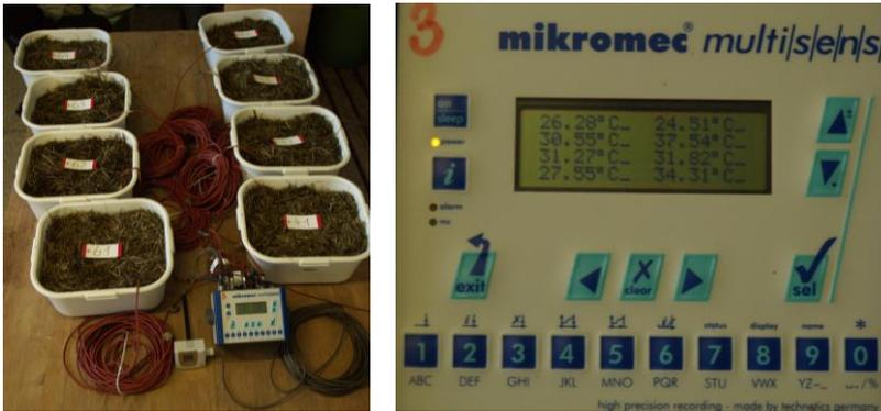
Abbildung 7: Equipment zur Prüfung der aeroben Stabilität
