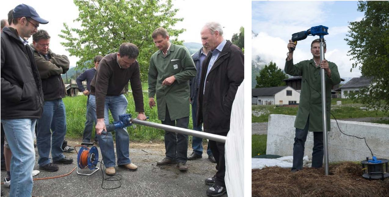
Im Eichungsseminar wurde die Probenmenge aus einem exakt vermessenen Bohrloch im Hinblick auf die Feststellung des Kubaturgewichts gewogen. Dabei wurden unterschiedliche Waagen im Vergleich zu einer geeichten elektronischen Waage getestet. Bei billigen Küchenwaagen kam es zu einem mittleren Messfehler von ca. +/- 20 kg TM/m<sup>3</sup>.
