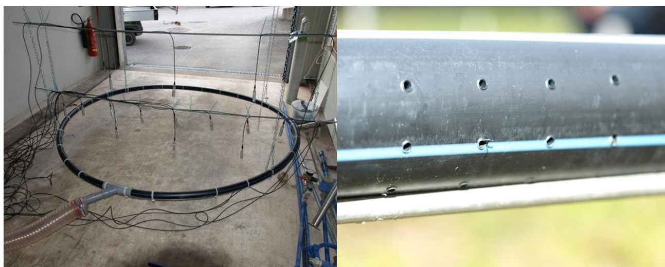
Abbildung 13. Konzeption und Test des Mini-FACE-Systems.
