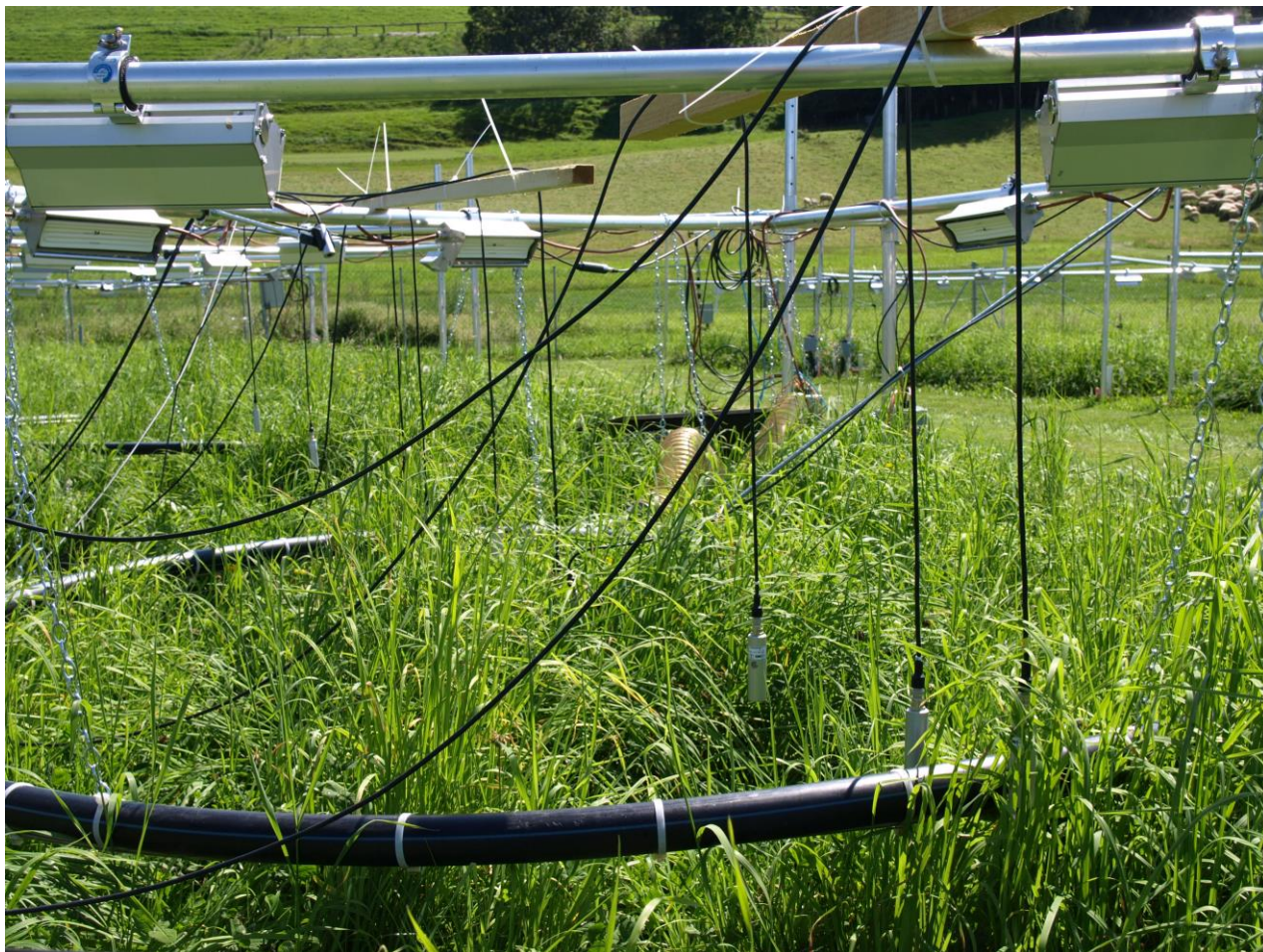
Abbildung 15. CO 2 -Sensorsystem zum Test der CO 2 -Verteilung in der Parzelle.
