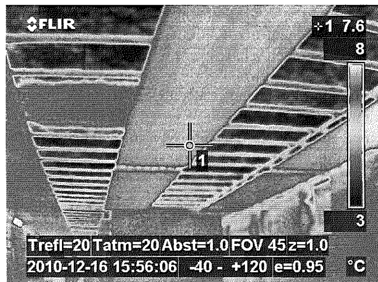
Abb. 4: Wärmebild mit Zuluft über Porendecke (Blau) und Heizung (rot-weiß)
