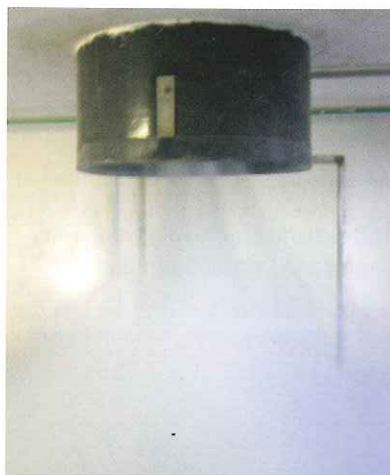
Hier ist der Kurzschluss mit Markie-rungsrauch sichtbar gemacht: Die Frischluft wird unmittelbar nach Ein-tritt ins Abteil wieder abgesaugt.
