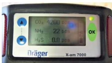
**Bild oben:** Dräger-Gerät zur Messung der Schadgaskonzentrationen.
