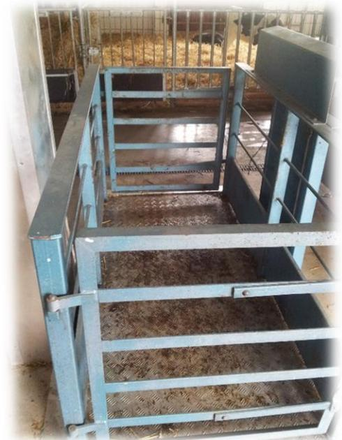
Abbildung 16: Brückenwaage zur Erfassung des Gewichtes
