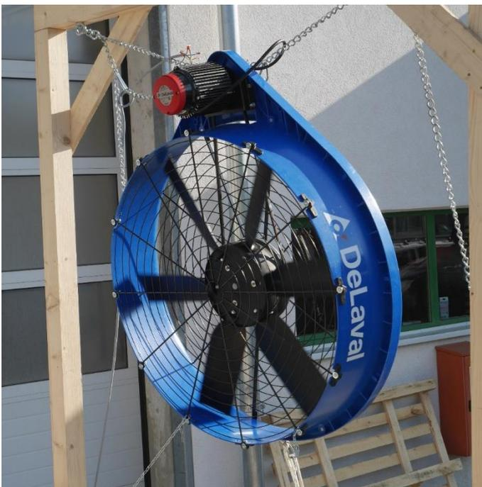
Abbildung 2 Axialventilator, Quelle: HBLFA Raumberg-Gumpenstein (2017)
