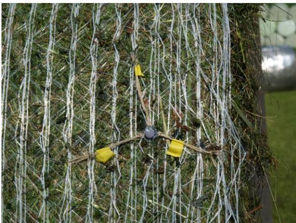
Abbildung 5: Montierter Spotsticker-Sensor (grauer Kreis)
