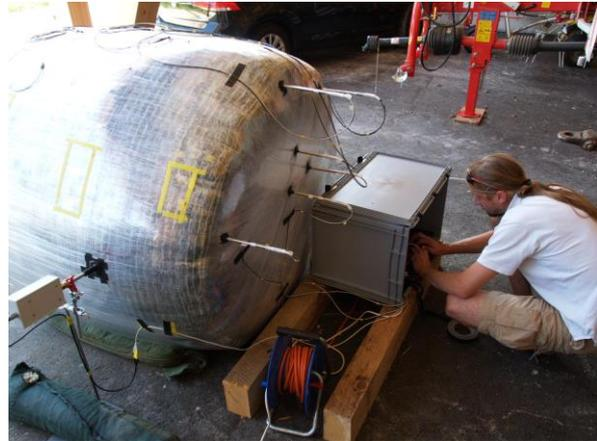
Abbildung 12: Messballen mit opto-chemischen Sensoren
