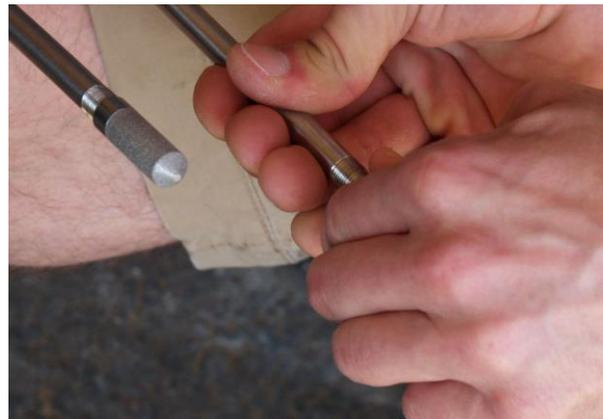
Abbildung 2: Poröse Metallkappe über Sensortechnik
