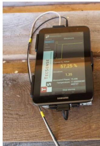
Abbildung 19: Manuelle Handheld-Messeinheit
