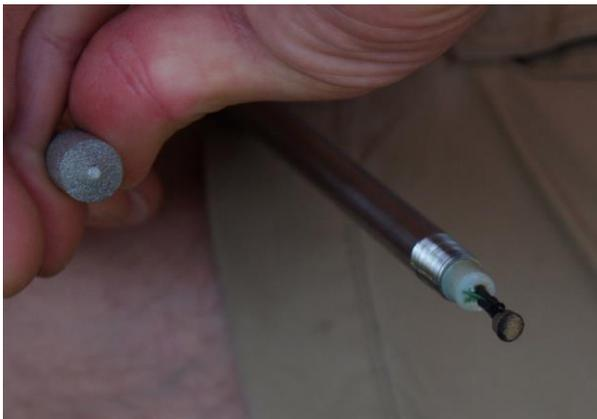
Abbildung 1: Faserkabelsensoren für Silierversuch S-64
