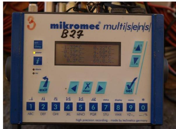
Die Installation erfolgte zeitmäßig parallel mit den opto-chemischen Sensoren von 10:40 bis 12:00 Uhr. Die Messintervalle wurden im 30-Minutentakt programmiert. Neben der Silagetemperatur wurden mit einem Kombifühler auch die Lufttemperatur neben dem Rundballen und die Luftfeuchtigkeit gemessen.
