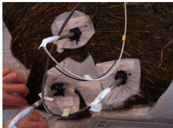
Abbildung 17: Fasersensoren nach Folienentfernung
