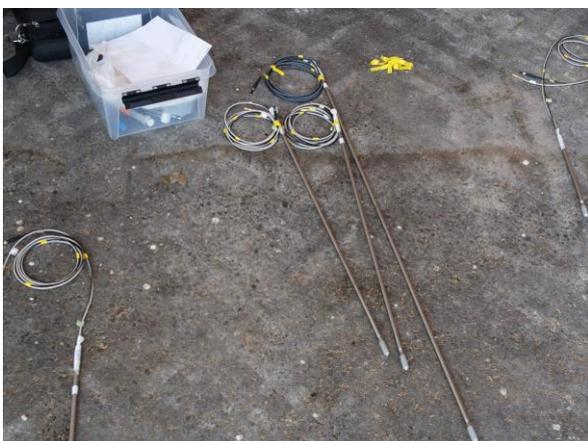
Abbildung 9: Faserkabelsensoren vor der Montage
