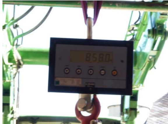
Abbildung 15: Kranwaagenanzeige bei der Ballenwiegun g
