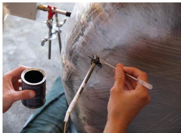
Abbildung 10: Abdichtung Faserkabelsensor nach Einbau
