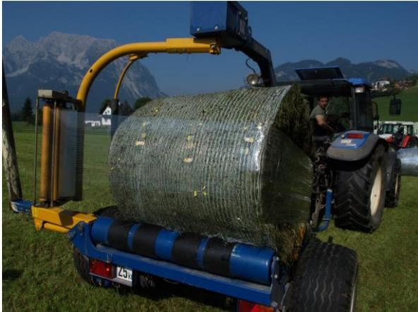
Abbildung 7: Wicklung Messballen mit Agristretch Crystal
