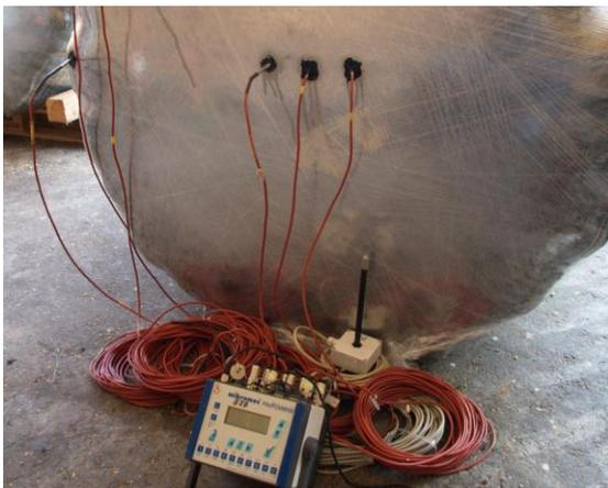
Abbildung 13: Temperaturmessung mit konventioneller Sensormesstechnik im Silierversuch S-64
