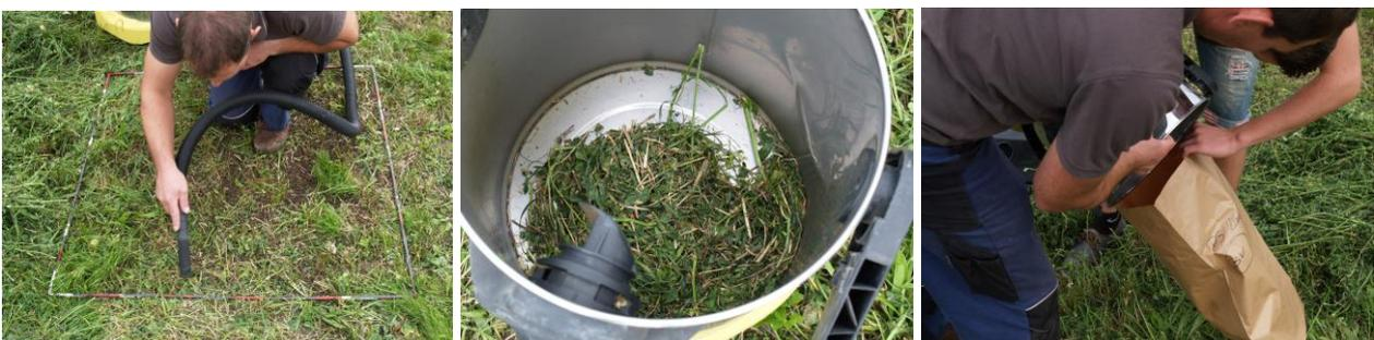
Abbildung 14: Erfassung der Bröckelverluste mit der Staubsaugermethode
