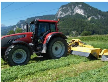
Abbildung 6: Mähschwadablage bei Aufbereitermahd
