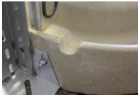
Dieses Loch in der Futterschale verhindert, dass das Futter im Vorratsbehälter nass wird, wenn die Ferkel die Schale mit Wasser vollmachen.
