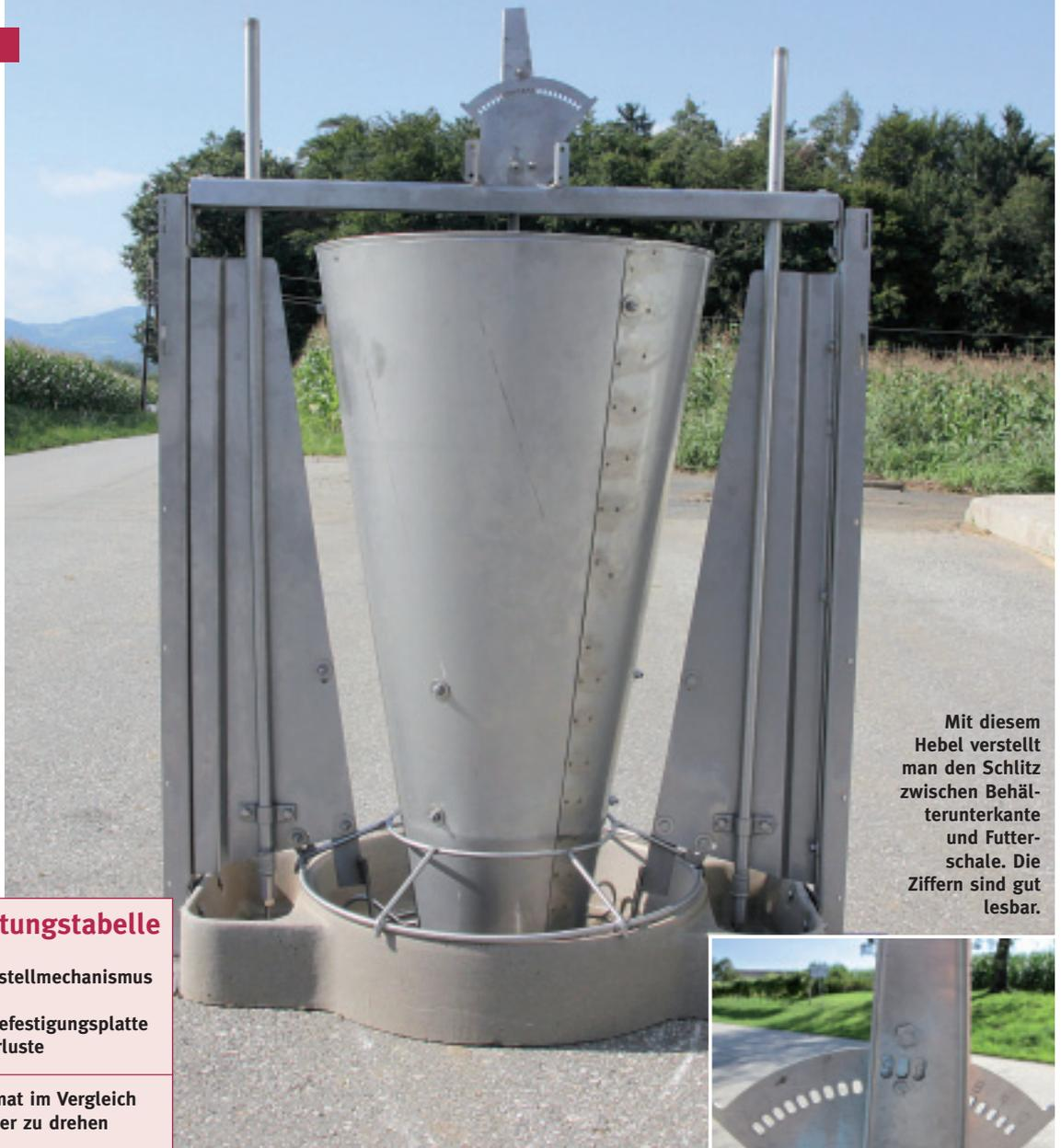
Mit diesem Hebel verstellt man den Schlitz zwischen Behälterunterkante und Futterschale. Die Ziffern sind gut lesbar.
