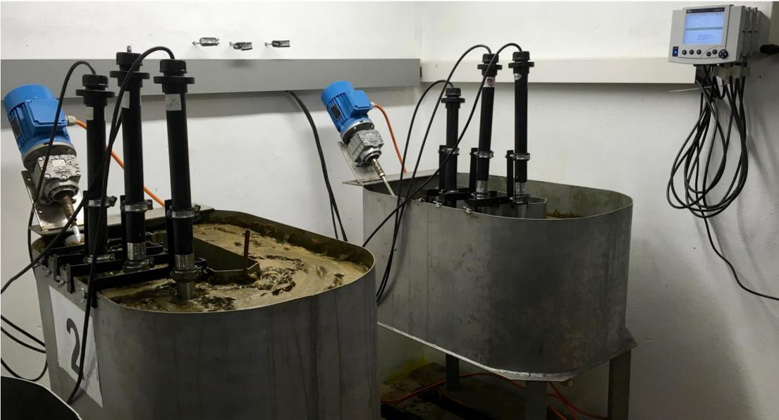
Abbildung 1: Gülleversuchsbehälter mit eintauchenden Rührwerken, Messsonden und Datalogger am Bio-Institut
