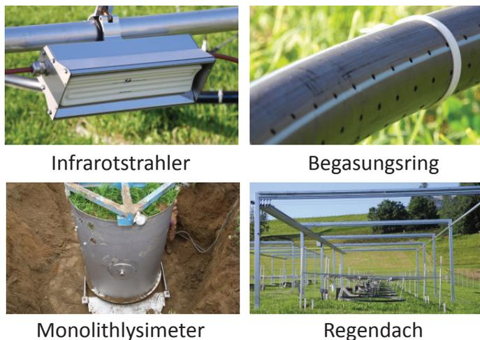
Abbildung 1: Funktionale, technische Elemente der ClimGrass-Anlage
