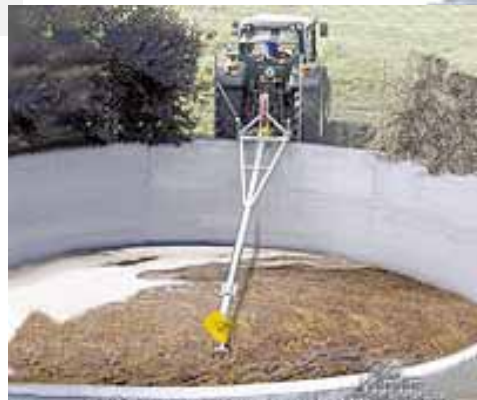
Traktoranbaumixer für geschlossene / offene Gülle- gruben / Hochbehälter / Lagunen
