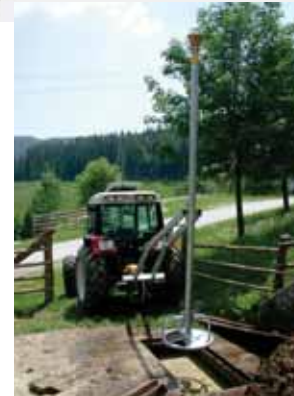
Traktoranbaumixer für geschlossene / offene Gülle- gruben / Hochbehälter / Lagunen
