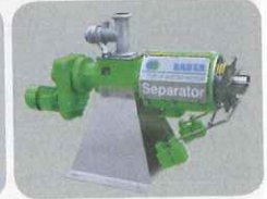
Separatoren zur Separierung von festen und flüssigen Nährstoffen, hoher Durchsatz
