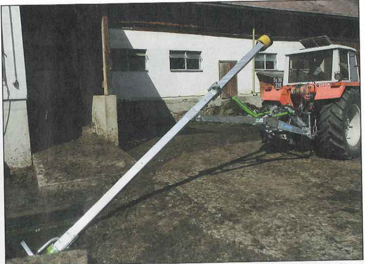
Ein Hydraulikzylinder in Kombination mit dem hydraulischen Hubgestell erleichtert das Einfädeln, ideal vor allem bei wechselnden Einsatzbedingungen und zu kleinen Grubenöffnungen.
