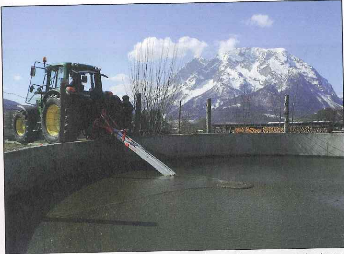
Außermittiges Rühren beschleunigt die Auflösung von Schwimmdecken.
