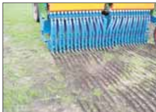
Bei der Schlitzdrillsaat hat das Saatgut besseren Bodenkontakt.
