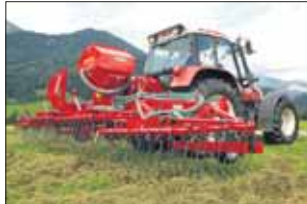
Der Anstellwinkel der Zinken lässt sich über Hebel verstellen.
