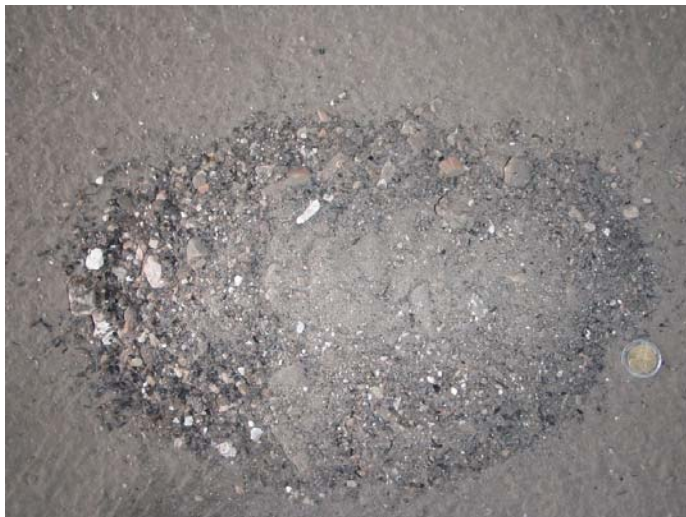
Bild 2: Grob- oder Rostasche ist in der Struktur sichtbar gröber als Kessel-, Zyklon- oder Feinflugasche
