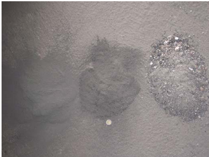
Bild 3: Feinstflugasche, Zyklonflugasche, Grob,- Rostasche im Vergleich
