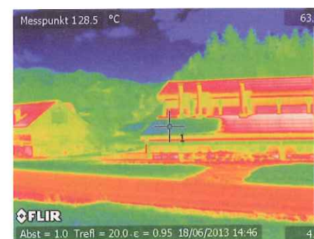
Abbildung 2: Wärmebild mit Sonneneinstrahlung und Wasserkühlung beim Messpunkt.
