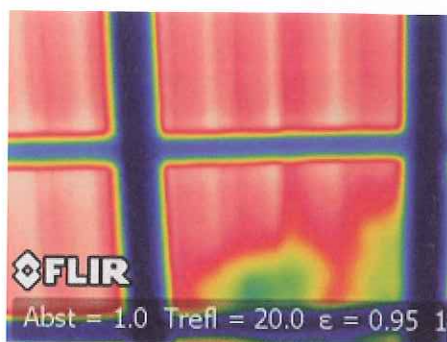
Abbildung 3: Ungedämmte Dachhaut im Auslauf.
