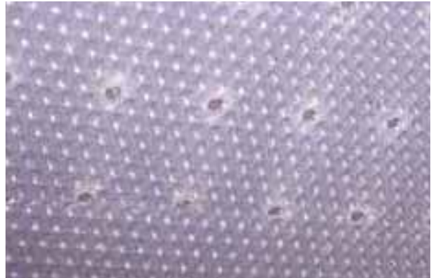
Abbildung 6: Doppellagige Kunststoffolie als Zuluftelement
