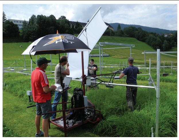
Abbildung 1: Mobile Messeinrichtung für die Ermittlung von Bestandeshöhen mittels Ultraschall und für feldspektroskopische Untersuchungen an den ClimGrass-Versuchspartellen
