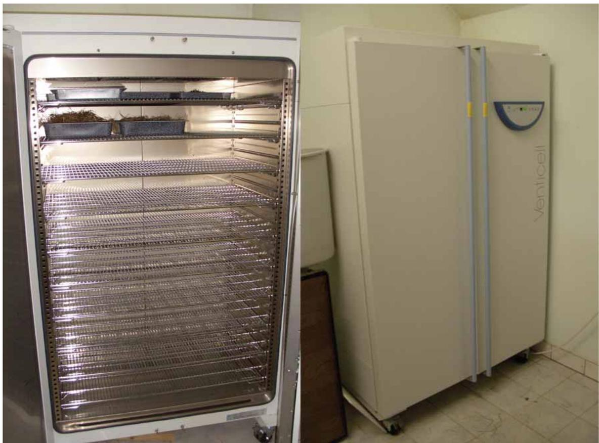
Abbildung 20: Der Trockenschrank von innen und außen
