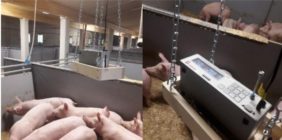
Abbildung 19: Messkorb mit Spectrometer 11-C im Ruhebereich der Tiere
