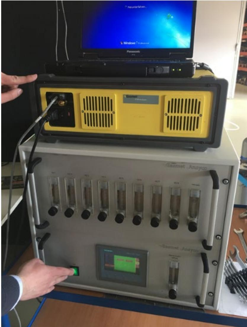
Abbildung 7: FTIR-Anlage der DLG Deutschland. Spektrometer + Sampler und Bedienungseinheit
