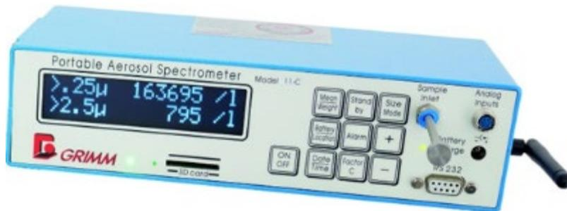
Abbildung 18: Grimm 11-C Aerosol-Spektrometer
