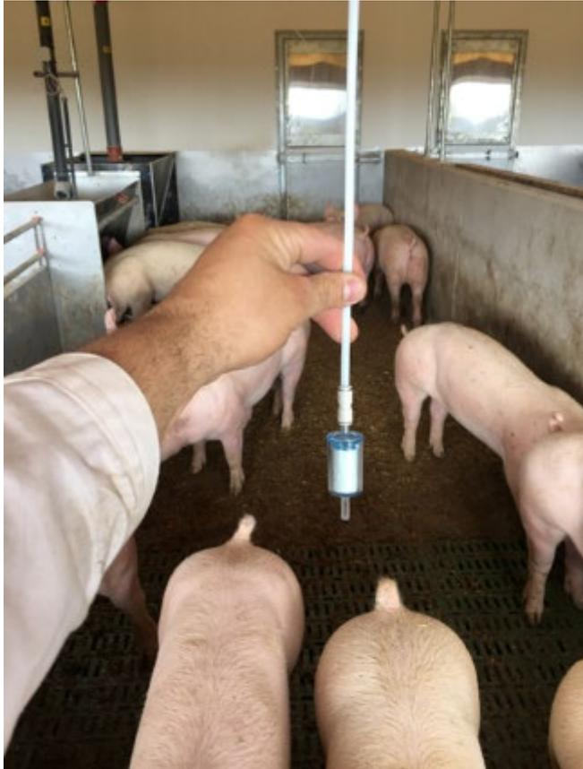
Abbildung 9: Gasmessleitung mit Staubfilter im Kotbereich
