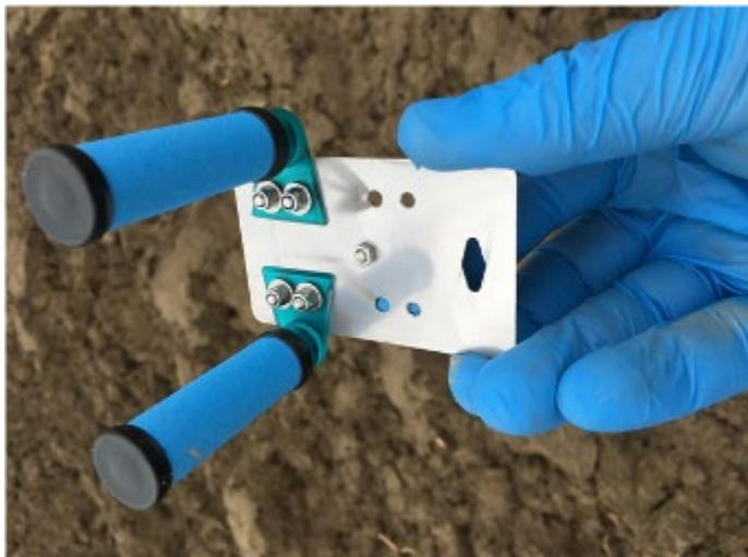
Abbildung 4: Zwei Radiellos in den Diffusionskörpern zur Erhebung der Ammoniakbelastung.
