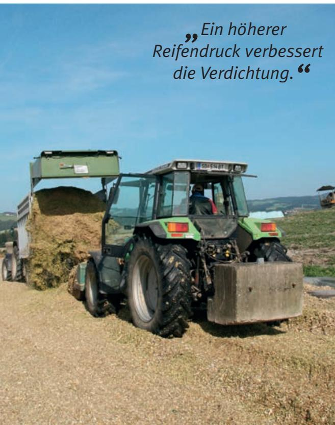
Legen Sie großen Wert auf eine gute Verdichtung durch schwere Geräte und dünne Schichten.
