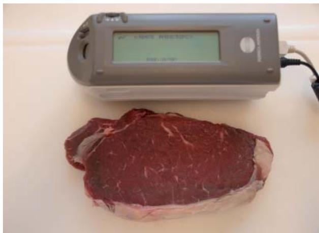
Abbildung 5: Farbmessung mit Spectrometer (Konica Minolta)
