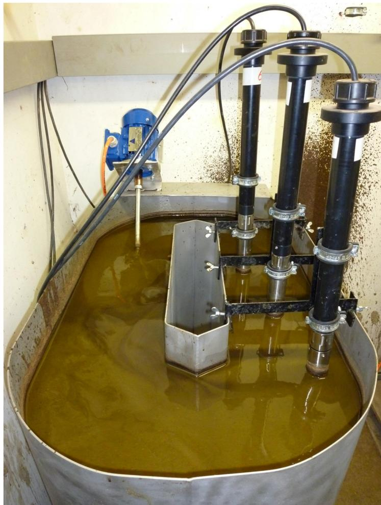
Abbildung: einer von drei Gülleversuchsbehältern während des Versuchsablaufs
