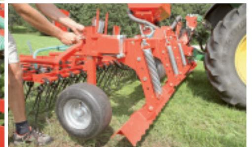
Höhenverstellung der Tasträder und federbelastete Planierschiene.
