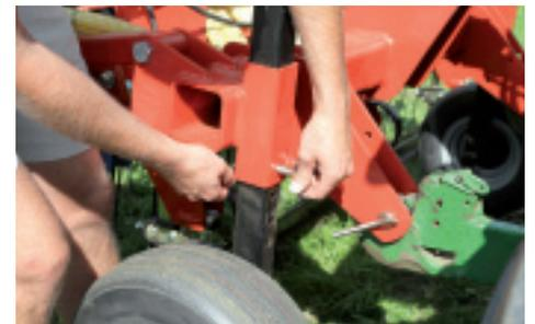
Die Höheneinstellung erfolgt über die Tasträder in Stufen.
