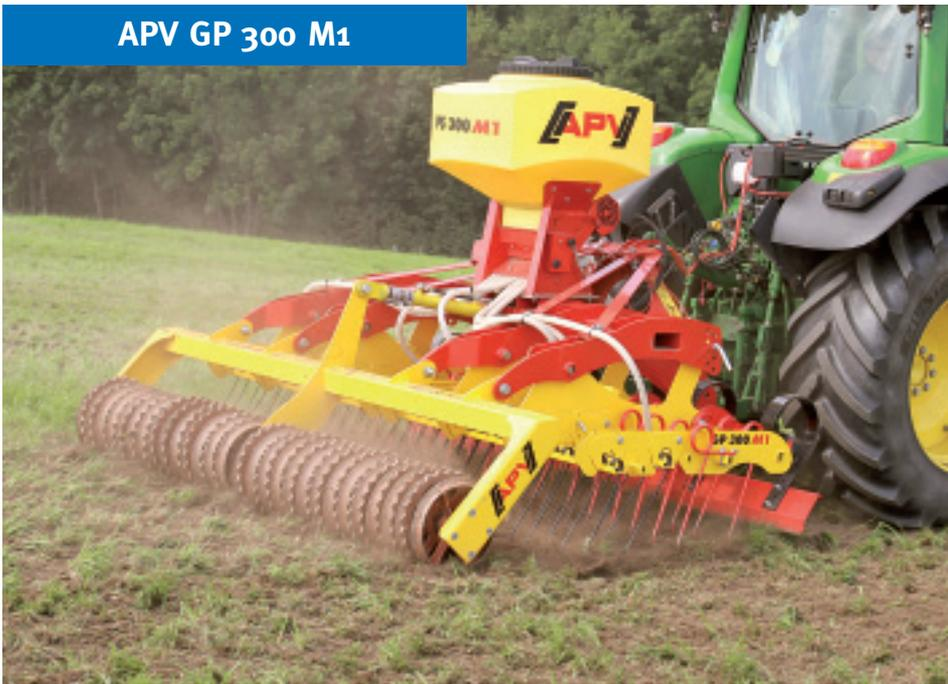
teren 8 mm-Zinken lassen sich mit einer Lochrasterung in der Neigung verstellen. Die einzelnen Striegelfelder sind 1,5 m breit und können sich in einem Bereich von 7 cm dem Boden anpassen. Das Blech unmittelbar vor den Striegelzinken dient der Einebnung von Maulwurfshügeln. Es wird in der Regel so eingestellt, dass es knapp über dem
