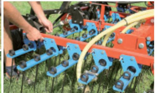
Die Neigungsverstellung muss bei jeder Zinkenreihe getrennt durchgeführt werden.
