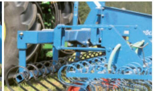
Gute Boden Anpassung dank parallelogrammgeführter Striegelfelder.
