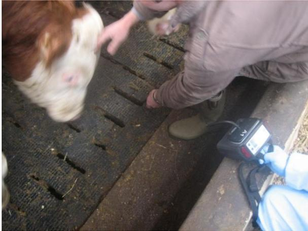
Abbildung 6: Multigassampller Dräger Xam 7000 im Tierbereich eingesetzt
