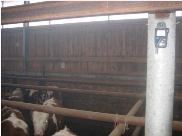
Abbildung 4: Datenloggermontage eines Testo 177 im Stall
