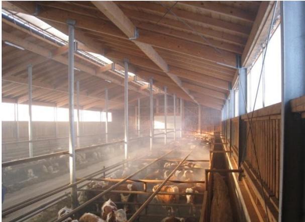
Abbildung 19: Thermik fördert Falschluff aus dem Gülle- in den Tierbereich
