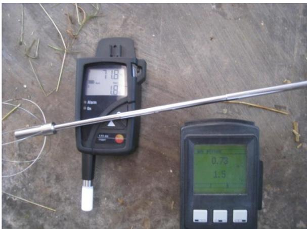
Abbildung 7: Behaglichkeitssonde (quer) mit Handmessgerät
