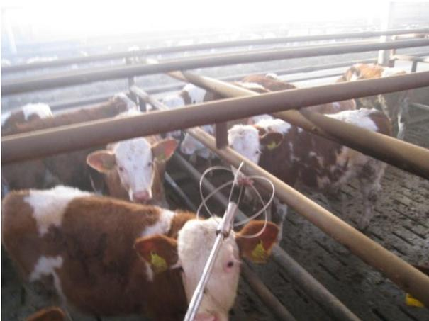
Abbildung 18: Messung der Luftgeschwindigkeit mit einer Behaglichkeitssonde
