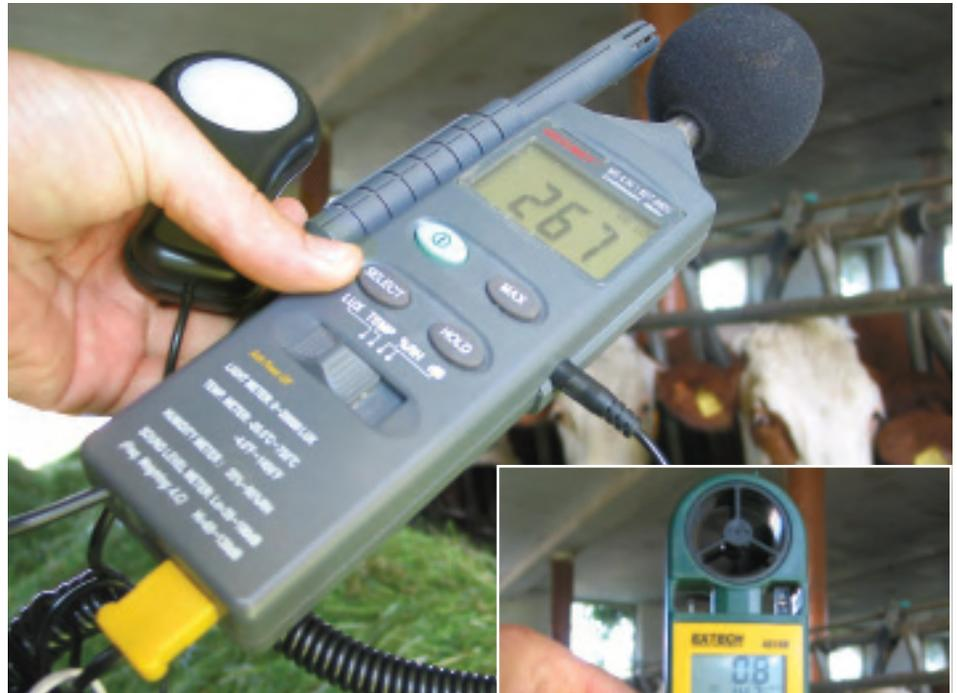
▲ Multifunktionsmessgeräte (Licht, Feuchte, Temperatur, Lärm, Luftgeschwindigkeit, Taupunkt) ▶
