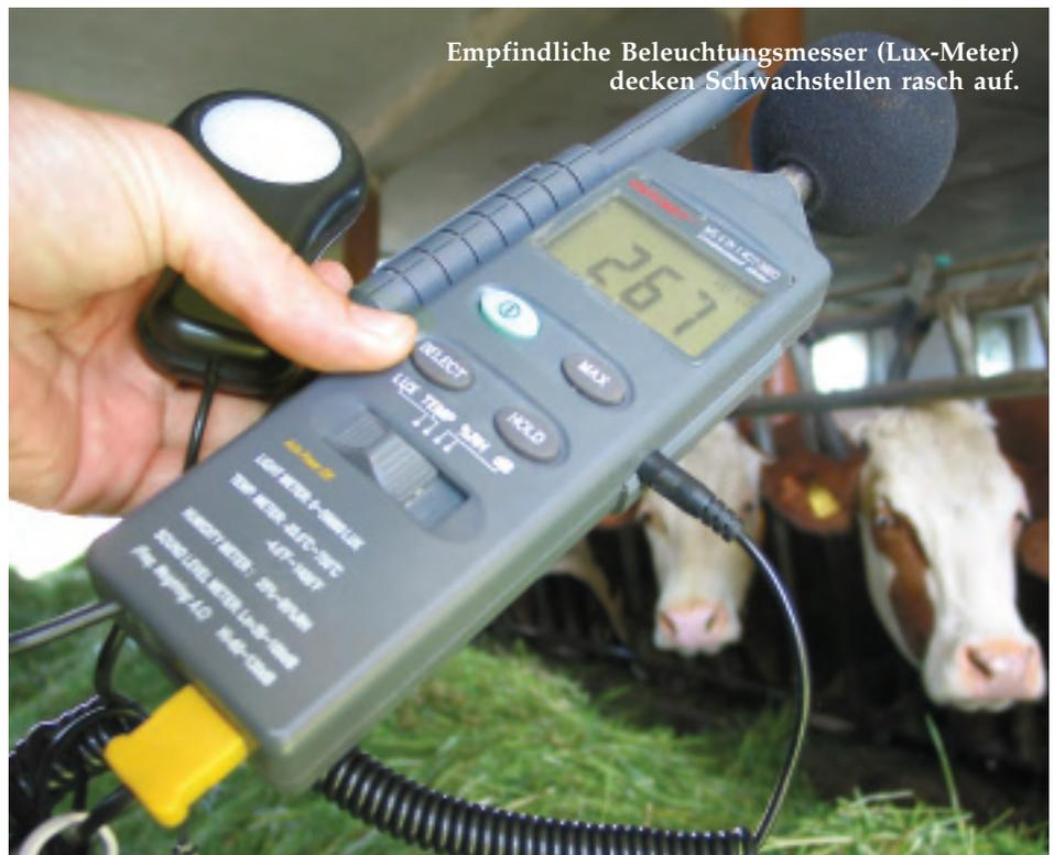
Empfindliche Beleuchtungsmesser (Lux-Meter) decken Schwachstellen rasch auf.
