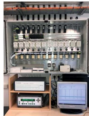
Abbildung 1: Messtechnik zur Erfassung der  $\text{NH}_3$ ,  $\text{CO}_2$ ,  $\text{CH}_4$  und  $\text{N}_2\text{O}$ -Emissionen
