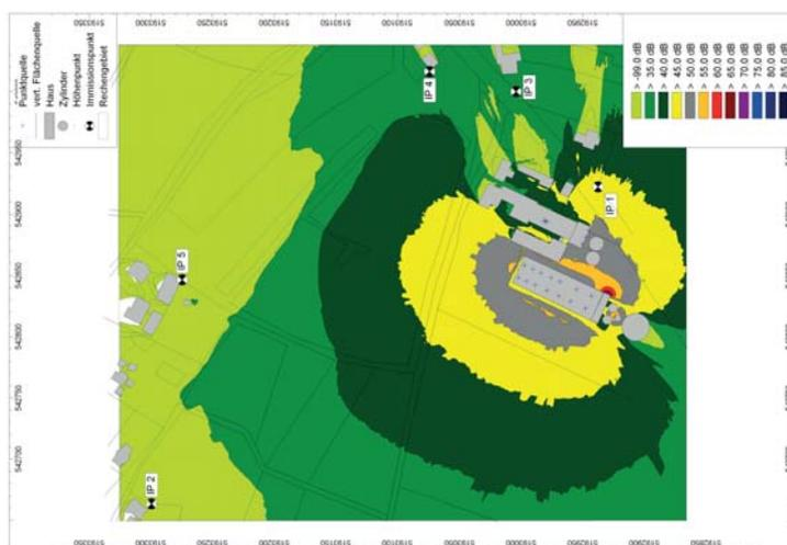
Abbildung 2: Lärmausbreitungsrechnung von einem Mastschweinestall
