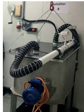
Abbildung 1: Gesamte Anlage (9 Behälter) im klimatisiertem Containercomplex- es können zeitgleich mehrere Wiederholungen an Rohgülle und Gülle mit Zuschlagstoff bemessen werden (Zentner A., 2020)
