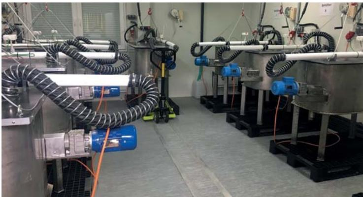
Abbildung 2: Gesamte Anlage (9 Behälter) im klimatisiertem Containercomplex- es können zeitgleich mehrere Wiederholungen an Rohgülle und Gülle mit Zuschlagstoff bemessen werden (Zentner A., 2020)
