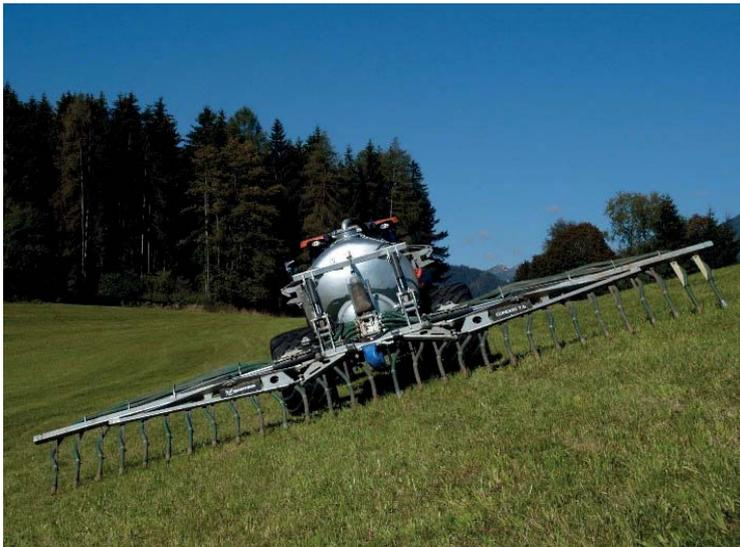
Abbildung 1: In Zukunft müssen mindestens 50 % der Rindergülle mit einem Schleppschuhverteiler ausgebracht werden. Davon ausgenommen werden nur Hangflächen ab 20 % Hangneigung sein.
