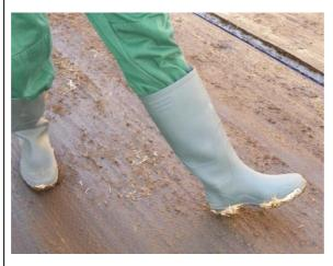
Abbildung 17: Anhand der Gummistiefelprobe kann die Rutschfestigkeit des Bodens ermittelt werden. © HBLFA Raumberg-Gumpenstein
