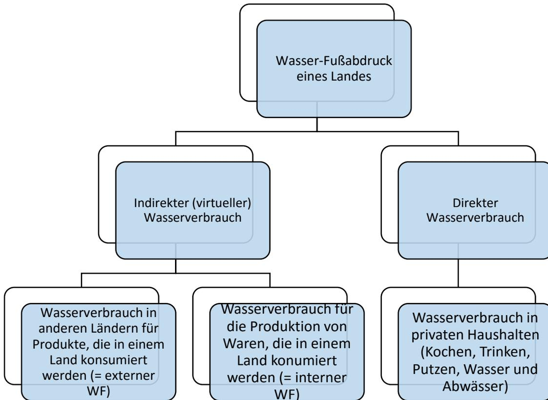
Schematische Darstellung der Komponenten, die in die Berechnung des Wasser-Fußabdrucks
