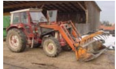
Frontlader mit Silozange zum Befüllen des Mischwagens
