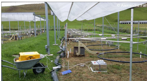
Abbildung 3: Gasmessung unter künstlichen Dürrebedingungen.
