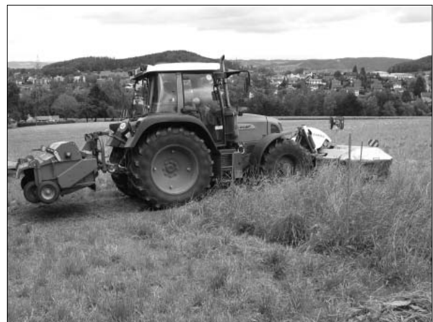
Abbildung 2: Verwendeter Traktor mit Trommelmähwerk (CLAAS corto 3150F, Mähbreite 3 m) und hinten montiertem Aufbereiter (Kurmman K618).
