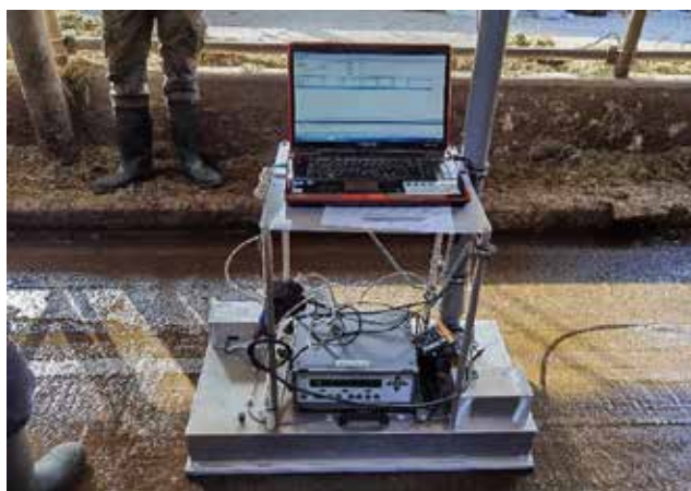
Abbildung 5: Gasmesshaube mit Gasmesstechnik (HBLFA Raumberg-Gumpenstein)
