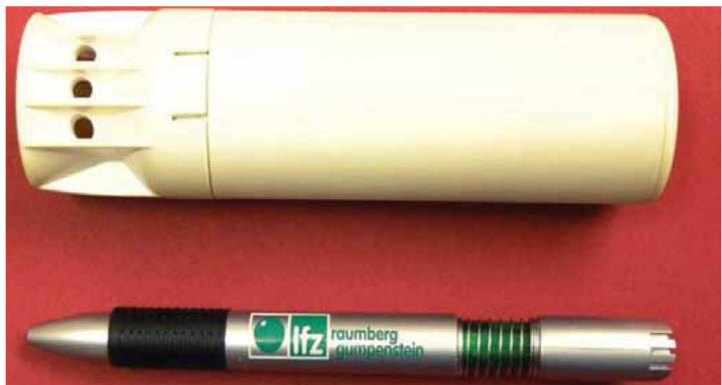
Abbildung 1: Der Sensor hat eine Länge von 12 cm, einen Durchmesser von 3,6 cm und wiegt 208 g.
