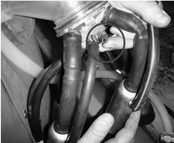
Einbau einer Drossel im Luftverteiler
