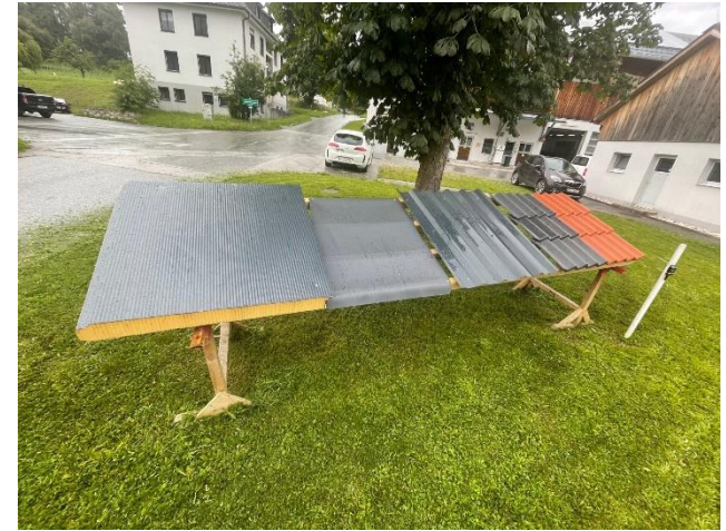
Untersuchung untersch. Dacheindeckungen in Raumberg-Gumpenstein (Foto: E. Zentner)
