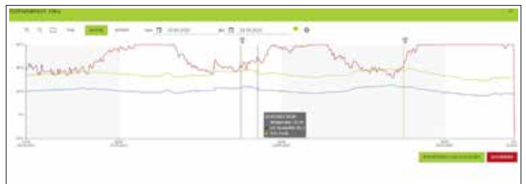
Diagramm eines Temperatur- und Feuchtigkeitssensors im Milchviehstall abgebildet. Die blaue Kurve zeigt die Entwicklung der Temperatur im Zeitverlauf, rot ist die relative Humidität, grün ist der THI. In diesem Beispiel stellt sich der Hitzestress erst nachmittags ein, da hier die Luftfeuchtigkeit und damit die gefühlte Temperatur ansteigt. In diesem Bereich wäre vermehrte Durchlüftung des Stalls anzuraten Quelle: smaxtec
