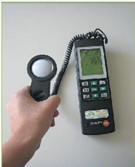
Luxmeter zur Messung der Beleuchtungsstärke. Mittels einer Sechsebenen-Messung wird in Tierkopfhöhe nach oben und nach unten sowie in alle vier Himmelsrichtungen ein Durchschnittswert ermittelt.
