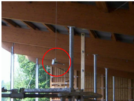
Abbildung 45: Messgerät zur Erfassung der Strahlungswärme mit Fühler
