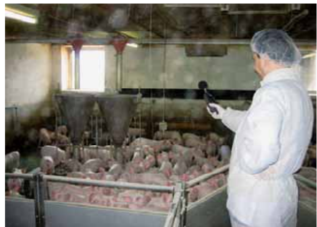
Abbildung 5: Messung des Innenpegels in einem Ferkelstall
