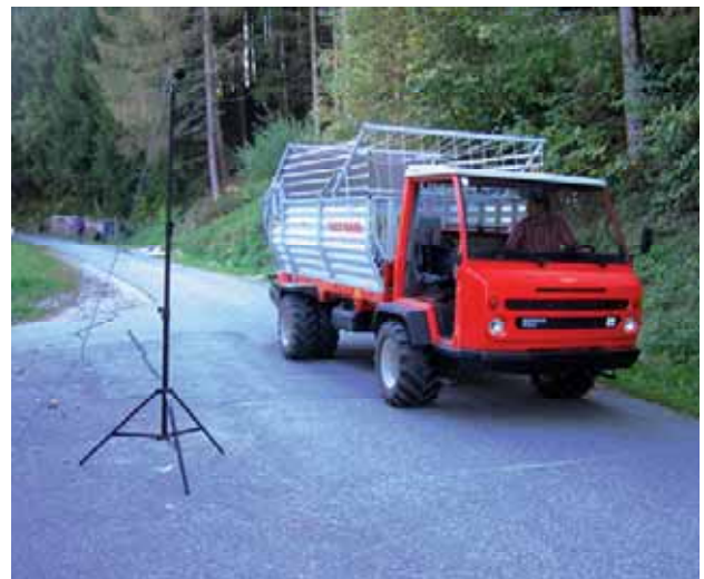
Abbildung 7: Arbeitsmessung eines landwirtschaftlichen Transportfahrzeuges
