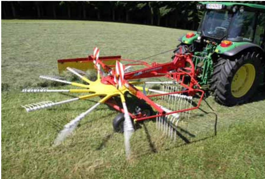
Abbildung 1.3: Einkreiselschwader Pöttinger 461N ( www.poettinger.at )
