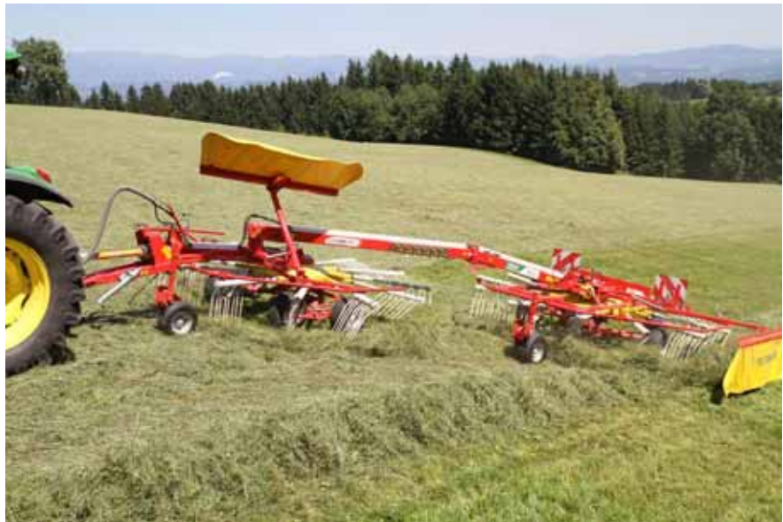
Abbildung 1.4: Zweikreiselschwader Pöttinger 691A ( www.poettinger.at )
