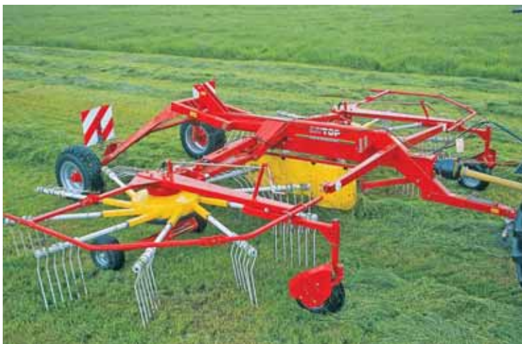
Abbildung 1.5: Zweikreisel-Mittelschwader von Pöttinger ( www.poettinger.at )
