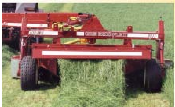
Abbildung 9: Mittige Zugdeichsel beim gezogenem Mähwerk
