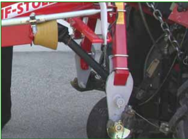
Bild 31: Abwinkelung der Gelenkwelle und Anbau Aufschubblasche
