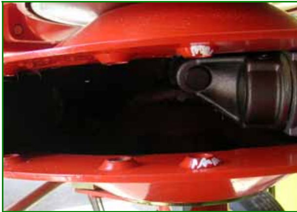
Bild 10: Ausbau Kurvenhebel mit Zinkenträgerlagerung
