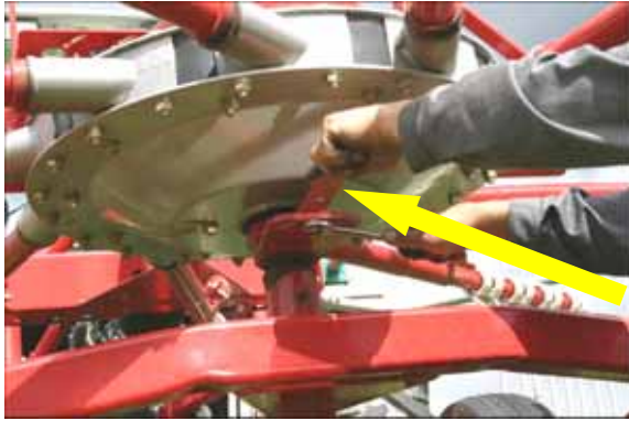
Bild 26: Kurvenscheibenverstellungshebel und Zinkenträgerausbau
