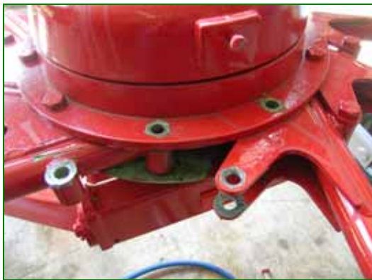
Bild 32: Ausbau der Zinkenträger
